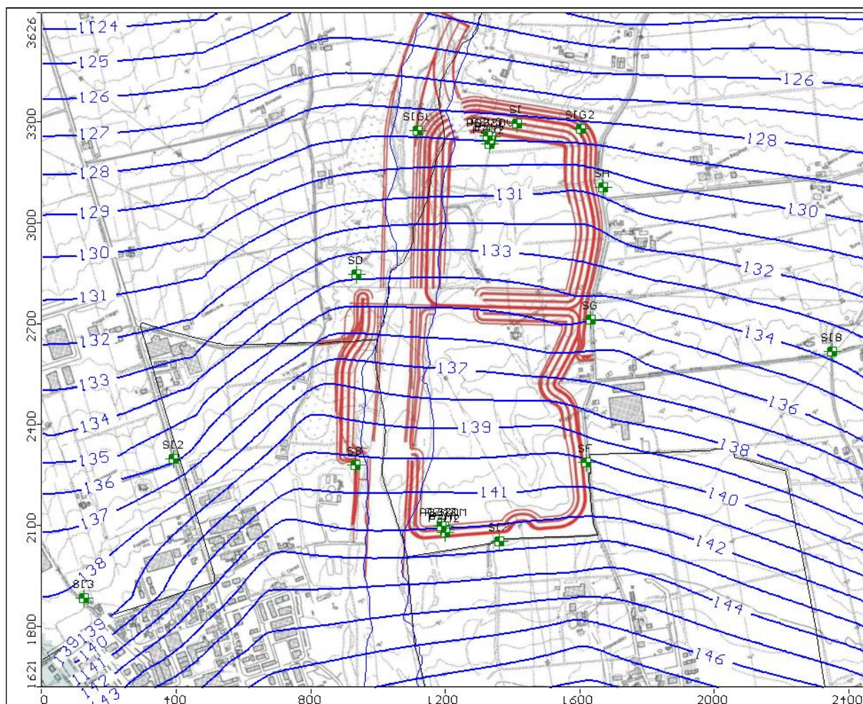
Figura 17 – Fase di taratura: Andamento piezometrico (m s.l.m.) – dettaglio della figura precedente
