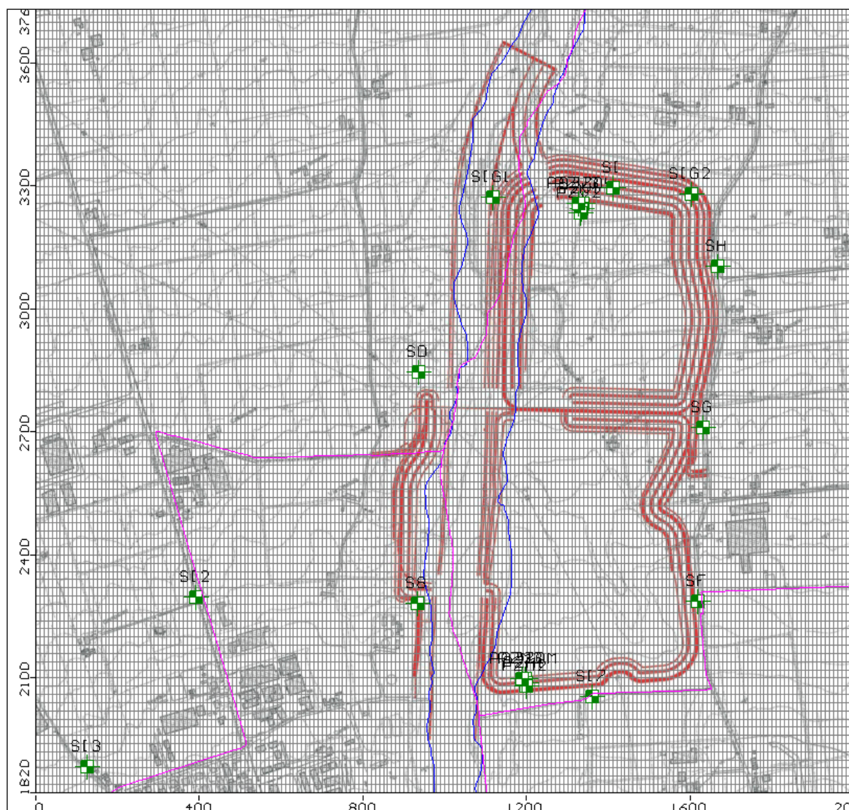
Figura 3 – Discretizzazione orizzontale del modello di flusso: dettaglio all'altezza della cassa di espansione sul T.Baganza
